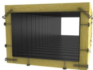
6.1 pav. Izoliacinių plokščių montavimas horizontaliam kanalui
