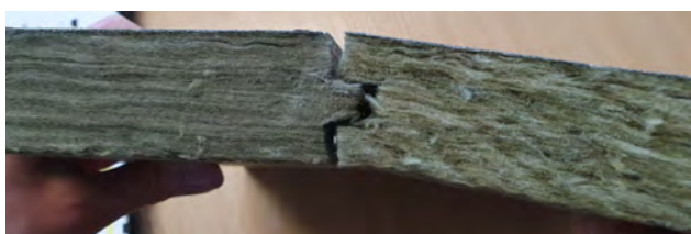
1 pav. Suleidimo įpjovos ISOVER Facade plokščių ilgosiose briaunose
