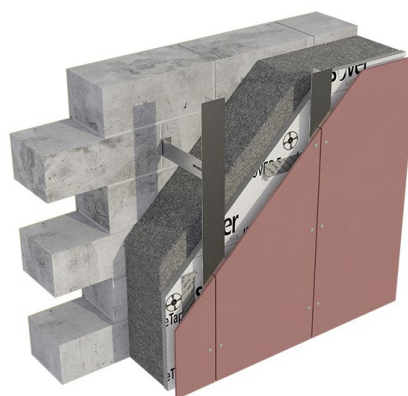
15 pav. Vėdinamas fasadas su nerūdijančio plieno kronšteinais (konsolėmis)
