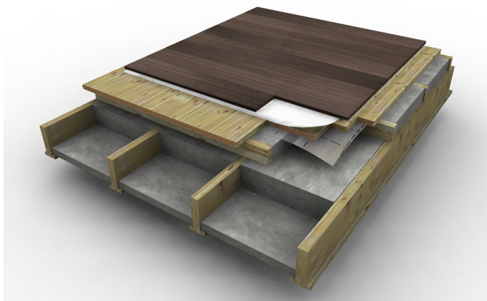
23 pav. Esamos vėdinamų grindų konstrukcijos papildomas šiltinimas
