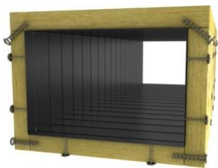
6.1 pav. Izoliacinių plokščių montavimas horizontaliam kanalui
